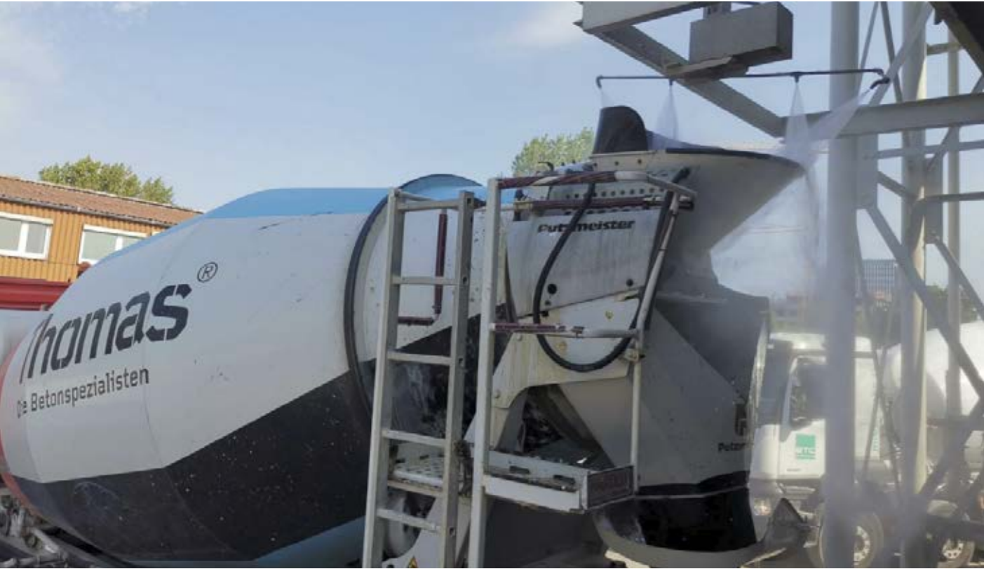
System półautomatycznego mycia leja, Thomas Beton (Niemcy).
